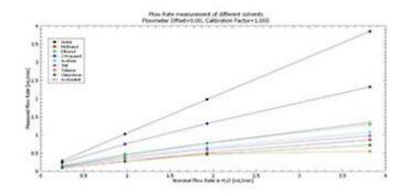
Bildunterschrift: Diagramm der scheinbaren Durchflussraten verschiedener Lösungsmittel
